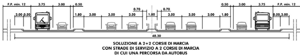
FIGURA 11.2 Caratteristiche geometriche trasversali delle strade urbane di scorrimento
