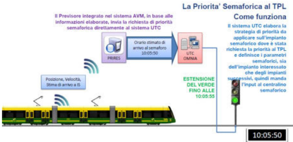
Figura 5-36 Schema di funzionamento priorità semaforica al TPL
