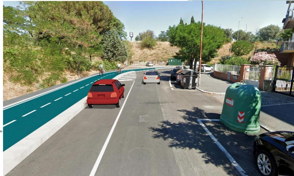
Pavimentazione con asfalto pigmentato riciclato
