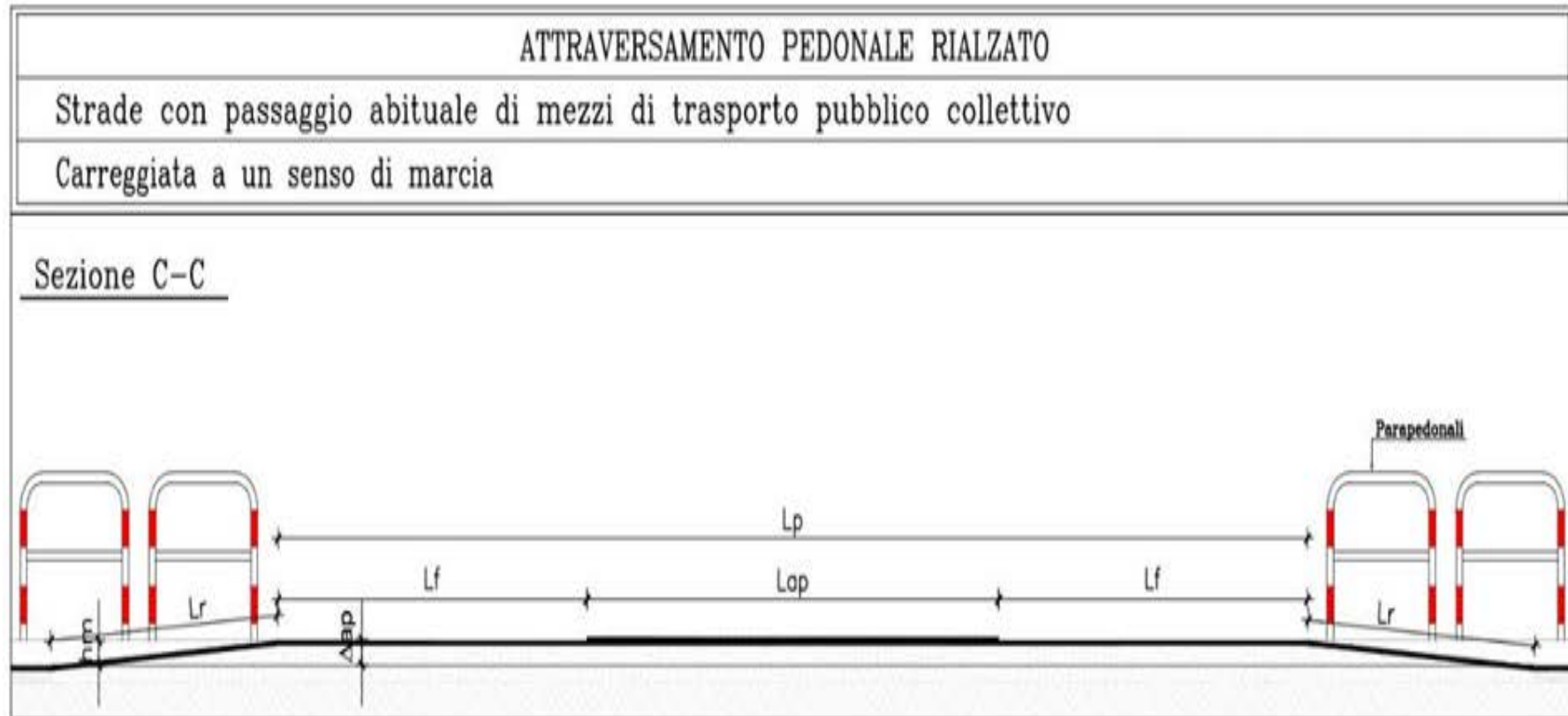
Figura 5B: Esempio schematico di sezione di attraversamento pedonale rialzato per carreggiata ad ad unico senso di marcia, con passaggio abituale di mezzi di trasporto pubblico collettivo
