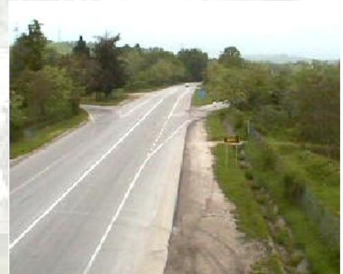
***Raccomandazione : Sfruttare meglio l'area sottostante l'opera di scavalcamento realizzando i tronchi di scambio. Tale intervento potrà essere realizzato modificando la segnaletica orizzontale ed allargando la pavimentazione***
