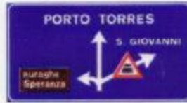
Figura 240 Art. 127 SEGNALE DI PREAVVISO DI INTERSEZIONE EXTRAURBANA CON PASSAGGIO A LIVELLO SU UN RAMO DELL'INTERSEZIONE
