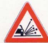
Figura II 29 Art. 98 MATERIALE INSTABILE SULLA STRADA
