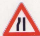
Figura II 18 Art. 90 STRETTOIA ASIMMETRICA A SINISTRA
