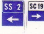
Figura II 270 Art. 129 NUMERO IDENTIFICAZIONE STRADA STATALE + FRECCIA E STRADA COMUNALE + FRECCIA CON FUNZIONE DI DIREZIONE *
