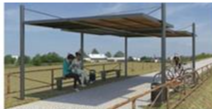
Piazzole di sosta coperte da pensiline con pannelli fotovoltaici per illuminazione ed alimentazione colonnine SOS e ricarica e-bike
