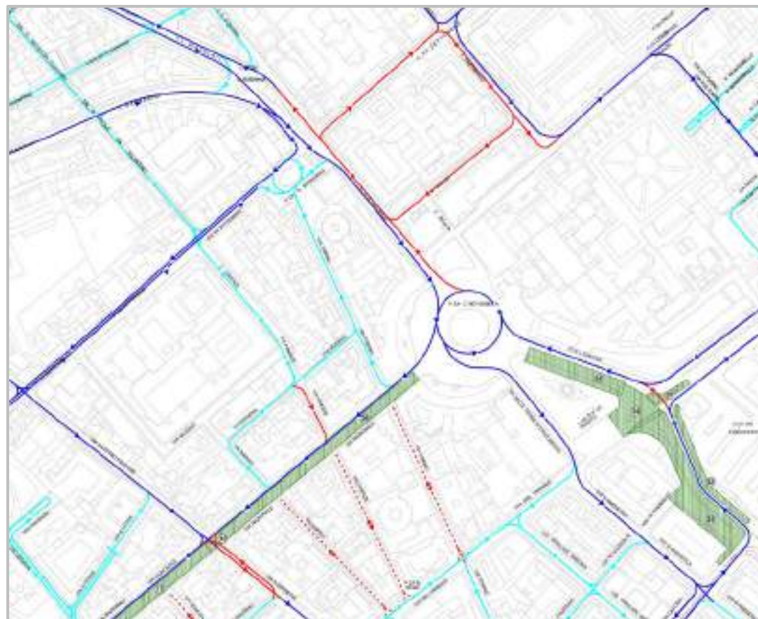
Figura 3-64 Schema circolazione di cantiere – prima macro fase: zona Termini – Nazionale
