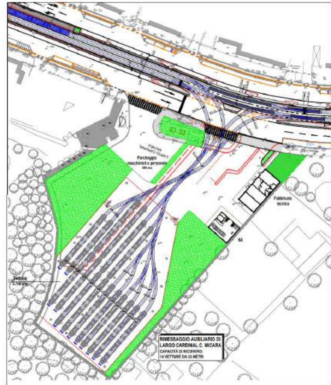
Figura 3-20 Layout di progetto del centro di rimessaggio di Largo Clemente Micara
