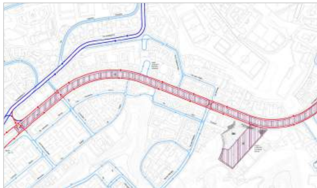
Figura 3-88 Schema circolazione di cantiere seconda macro fase: zona Gregorio VII – Pio XI
