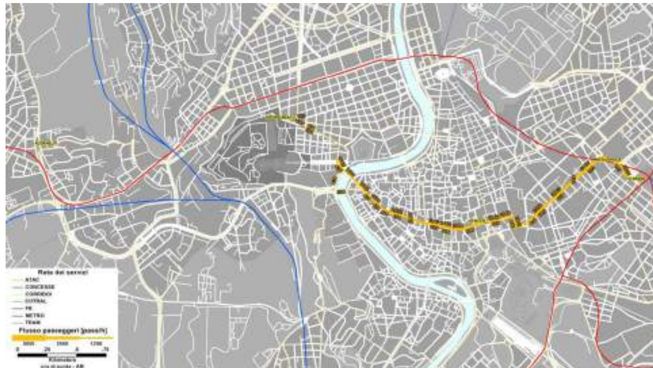
Figura 3-40. Diagramma di carico servizio Termini-Vaticano
